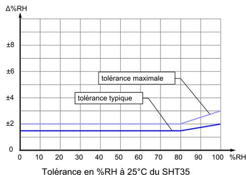
La précision de la mesure d'humidité dépend aussi de la température ambiante. La tolérance typique de la mesure d'humidité en fonction de l'humidité et de la température est documentée sur le graphique ci-dessous.
