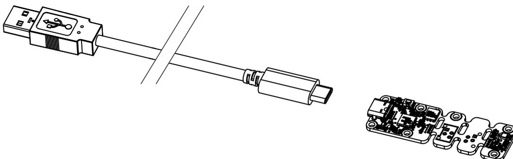
Vous devez raccorder votre module Yocto-Meteo-V2-C à l'aide d'un cable USB 2.0 de type A - type C
