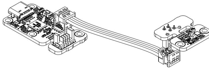
Déport du capteur à l'aide de connecteurs Picoflex.
