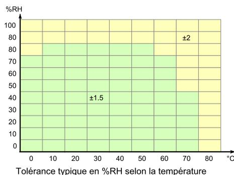
La précision absolue de la mesure de température elle-même est typiquement de  $\pm 0.1^\circ\text{C}$  entre  $20^\circ\text{C}$  et  $60^\circ\text{C}$  (résolution de  $0.01^\circ\text{C}$ ), ou  $\pm 0.2^\circ\text{C}$  entre  $-30^\circ\text{C}$  et  $90^\circ\text{C}$ . La tolérance maximale est documentée sur le graphique ci-dessous. La répétabilité est de  $0.06^\circ\text{C}$ .
